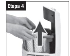
Retire el soporte de filtro y bote el filtro usado.
